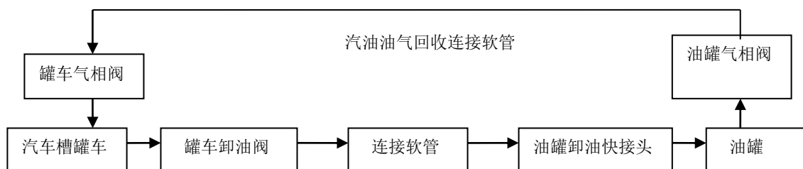
图 2-2 汽油卸油工艺流程示意图
