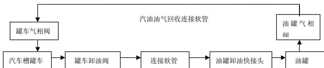
图 2-2 汽油卸油工艺流程示意图
